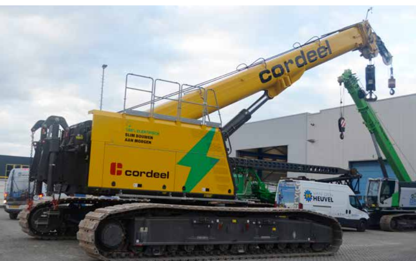
Voor Cordeel bouwde het Nederlandse Van Den Heuvel een Sennebogen 6113 hijskraan met Stage V dieselmotor om tot een full electric machine met range extender.
