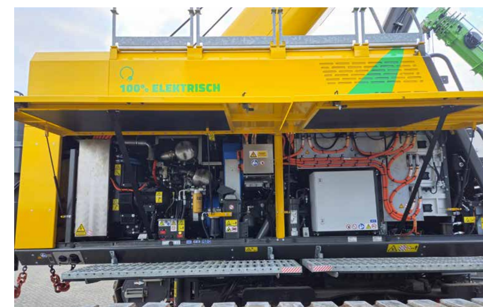
Hybride machines zijn in essentie volledig elektrisch, maar beschikken over een back-up in de vorm van een stage V dieselmotor.
